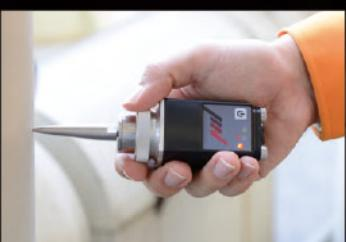
使用专用探杆(标准配置)直接测量，可以采集需要的振动值，而且不用担心电缆线会卷入机器的顾虑，安全测量。
